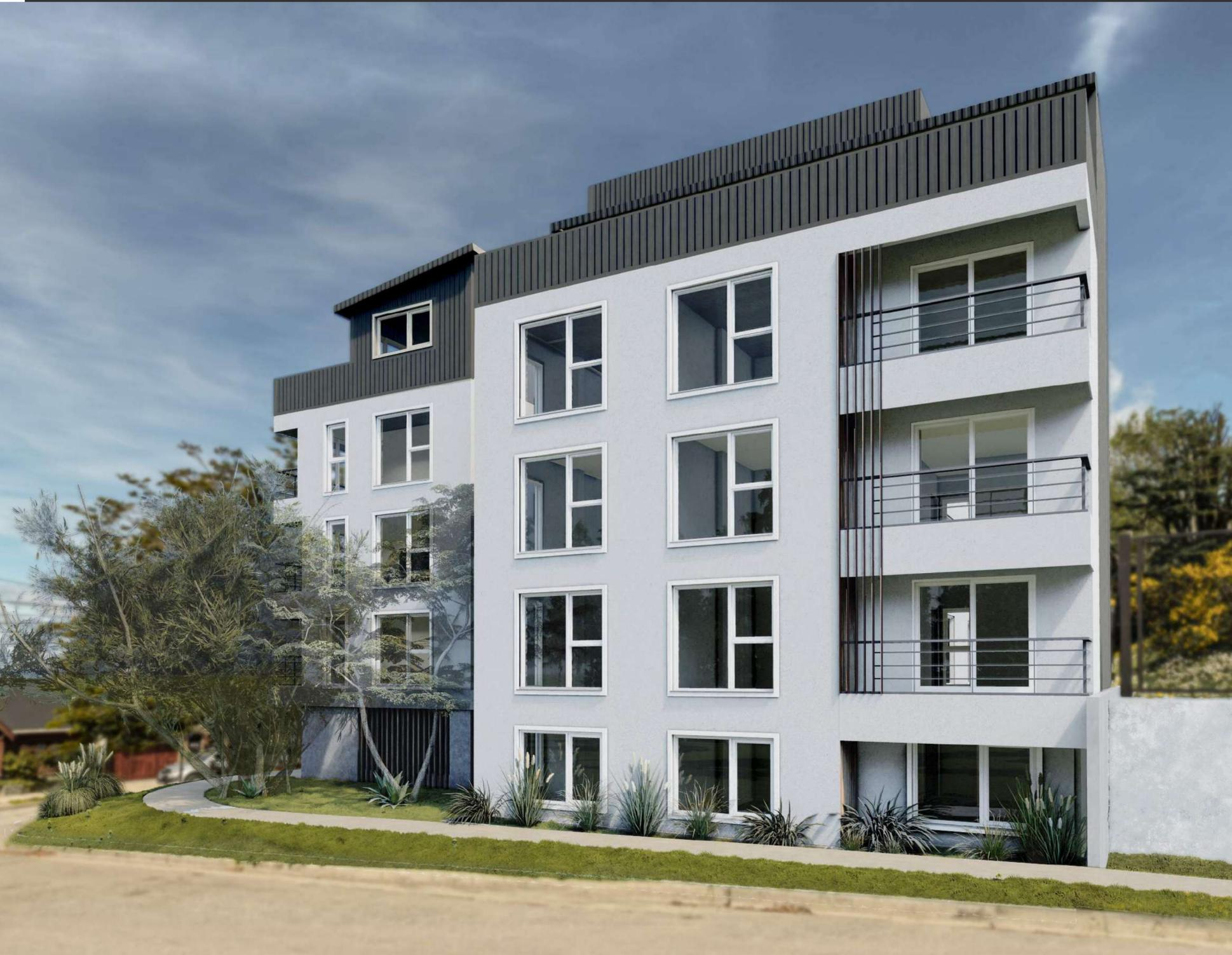
Estructura de hormigón armado anti-sísmico. Muros medianeros y separación entre departamentos de mampostería.
